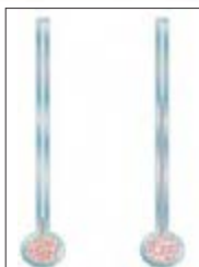
شکل ۳. وقتی دما کم باشد، ارتفاع الکل یا جیوه در لوله کم است و با افزایش دما، ارتفاع مایع زیاد می‌شود.
