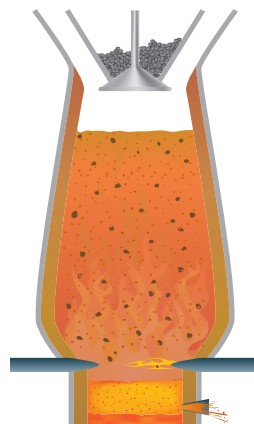
(پ) گرما دادن مخلوط سنگ آهن، کربن و سنگ آهک (ت) تولید ورقه‌های فلز آهن در کوره
