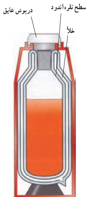
شکل ۱۳. دما بان خلأ می‌تواند مدت نسبتاً زیادی دمای جسم را تقریباً ثابت نگه دارد.
